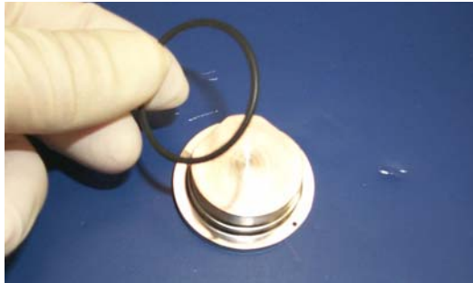
Abbildung 4-18 Herausnehmen des O-Rings aus dem Magnetpolblock
