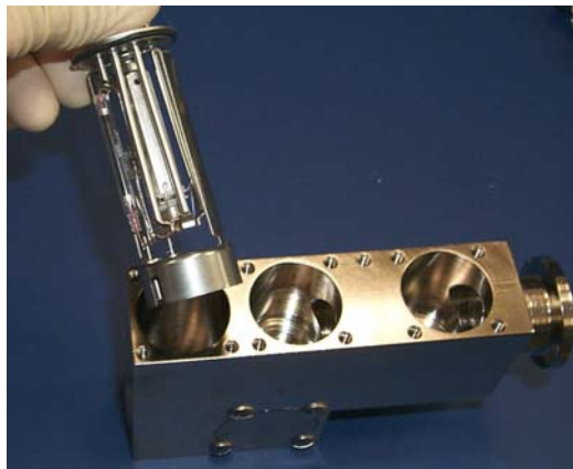
Abbildung 4-16 Ausbauen des Vorverstärkers
