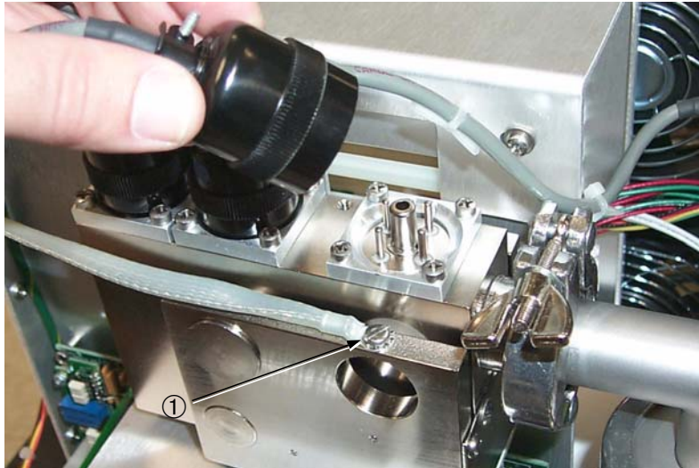
Abbildung 4-3 Abziehen der Anschlüsse
