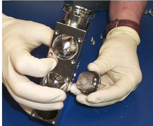
Abbildung 4-19 Herausnehmen des zweiten Magnetpolblocks
