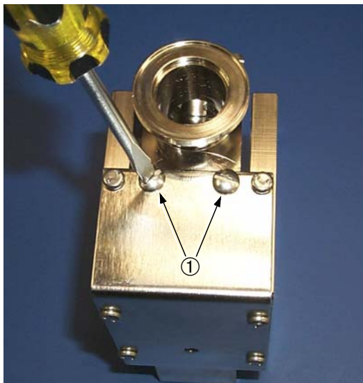
Abbildung 4-7 Schlitzschrauben an der Magnetbaugruppe
