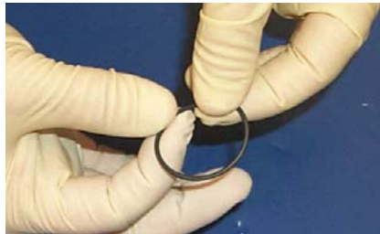
Abbildung 4-23 Überprüfen des O-Rings
